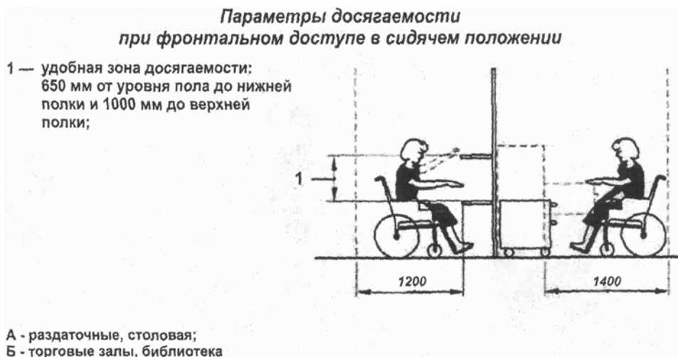
Рисунок Д.2. Зоны досягаемости и эргономические параметры
