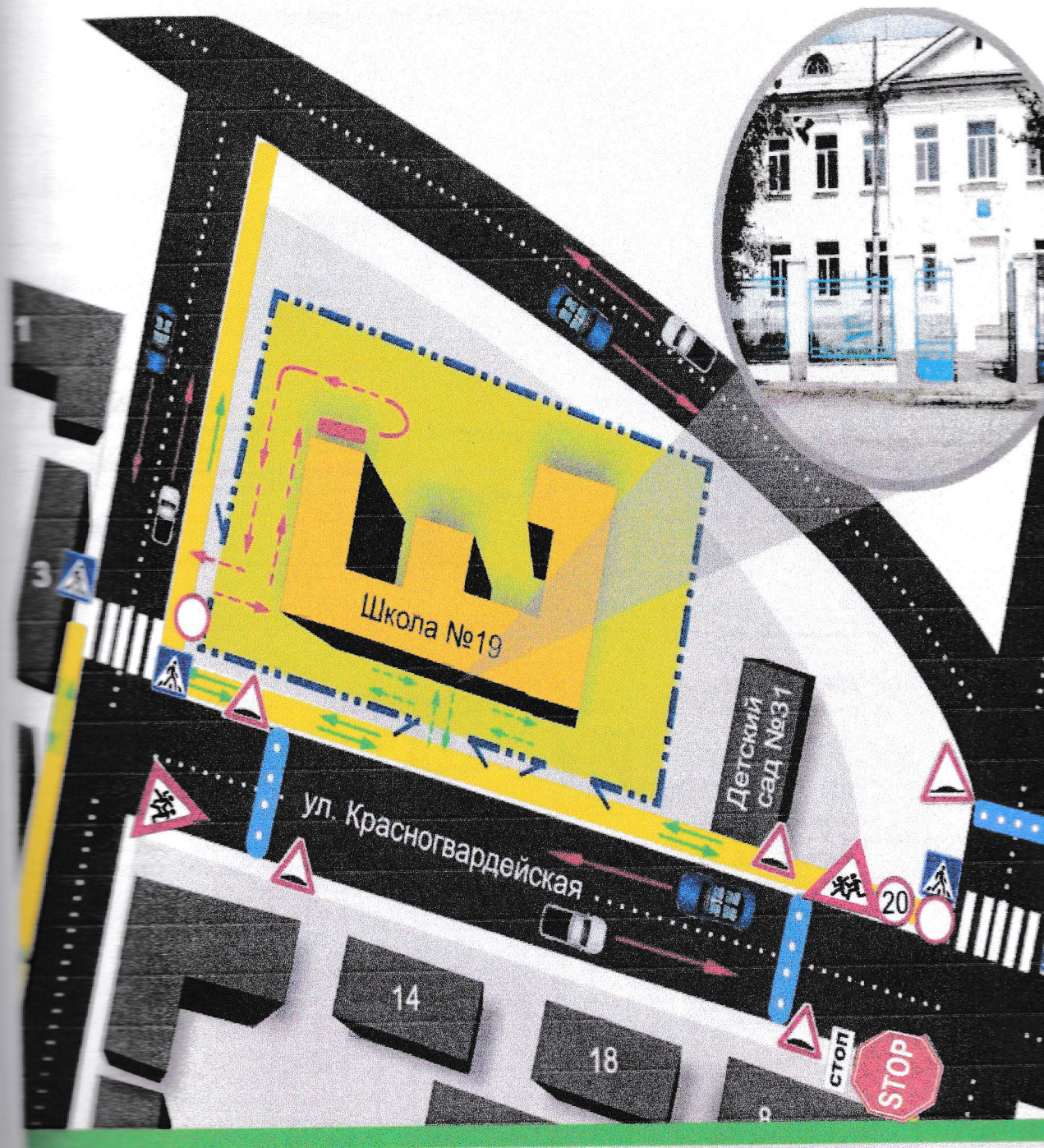
2. Схема организации дорожного движения в непосредственной близости от образовательного учреждения с размещением соответствующих технических средств организации дорожного движения, маршрутов движения детей.
