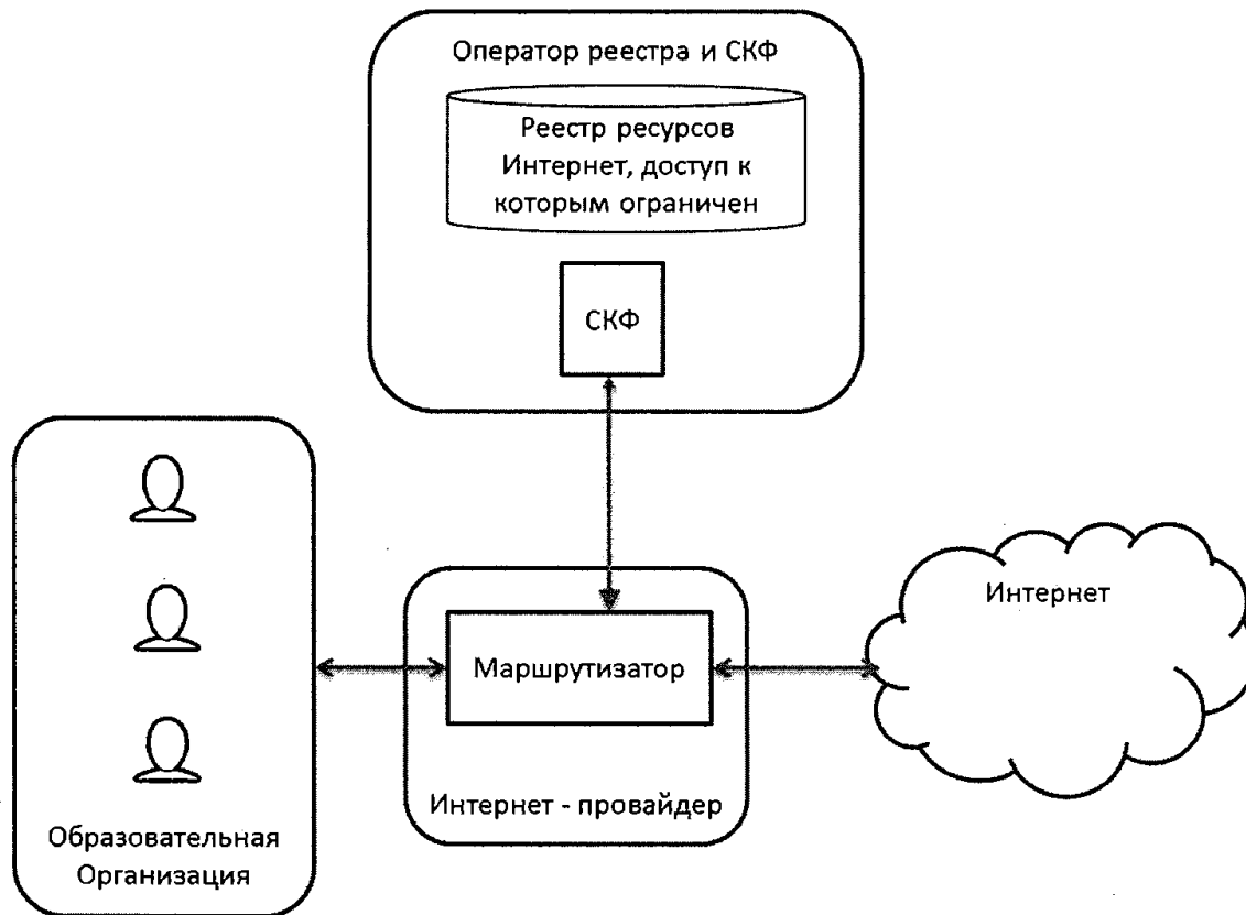
Рисунок 5. Схема работы контент-фильтрации при едином решении
